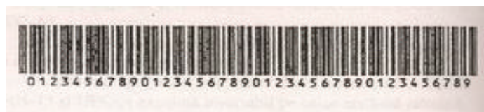
Figura 2 - Eticheta tipului de cod barat interleaved 2of5, care nu a necesitat adăugarea unei guard bar centrale. Cu alte cuvinte, era posibilă și alcătuirea într-o altă modalitate a structurii tipurilor EAN și UPC.
